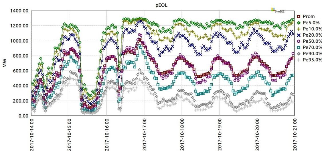
Fig 4: Generación eólica cortes de probabilidad en horas.
